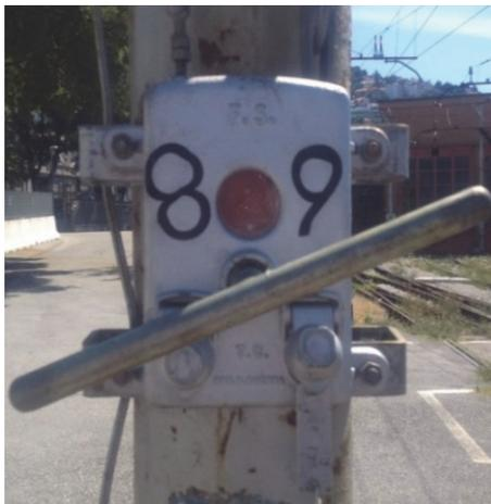
**Fig. 7: Argano in posizione di chiuso**
